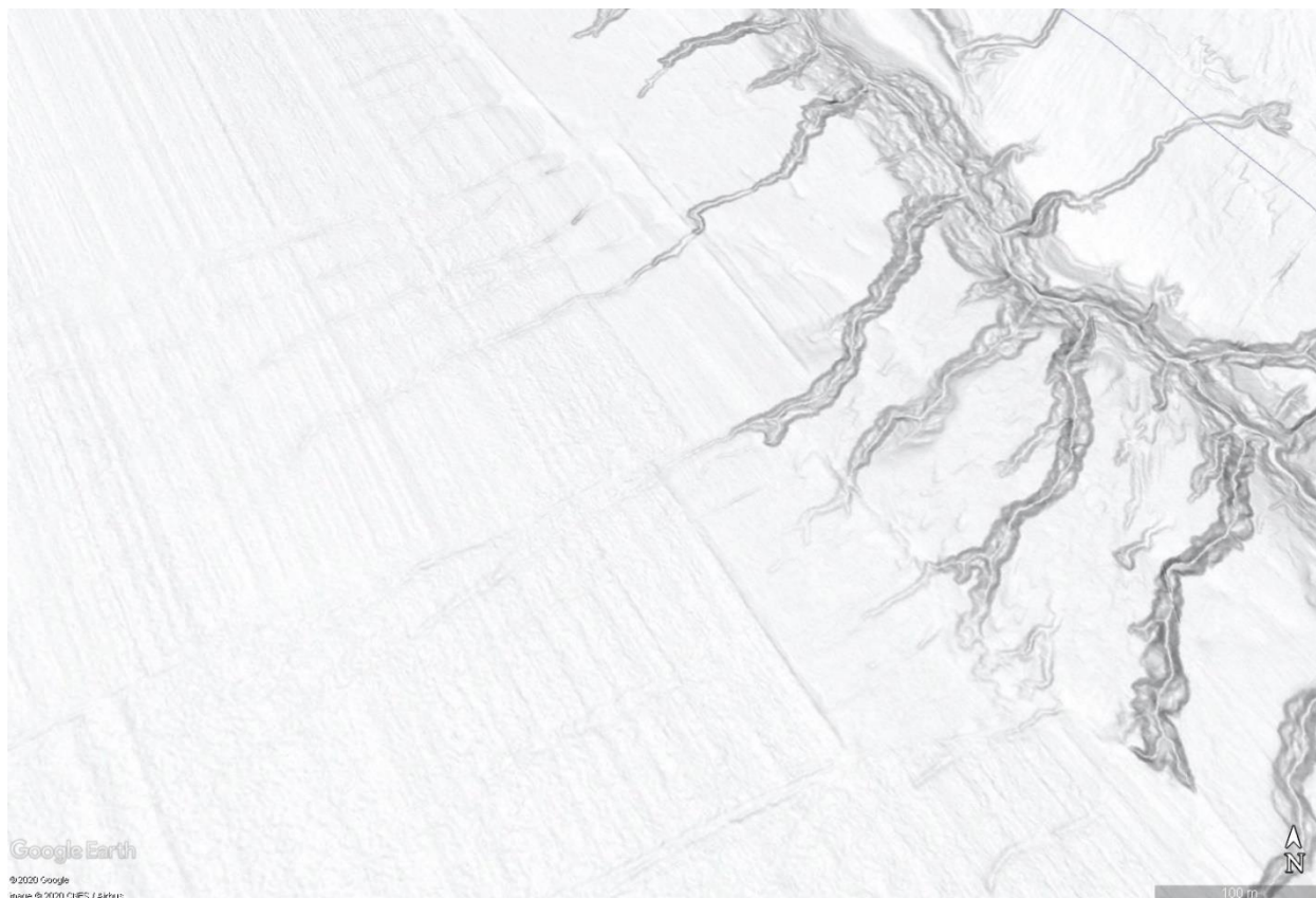
Figura 62 Rigole care fac trecerea către ravene în zona Lupăria, jud. Botoșani (captură model numeric al terenului LiDAR cu rezoluție de 0,5 m)
