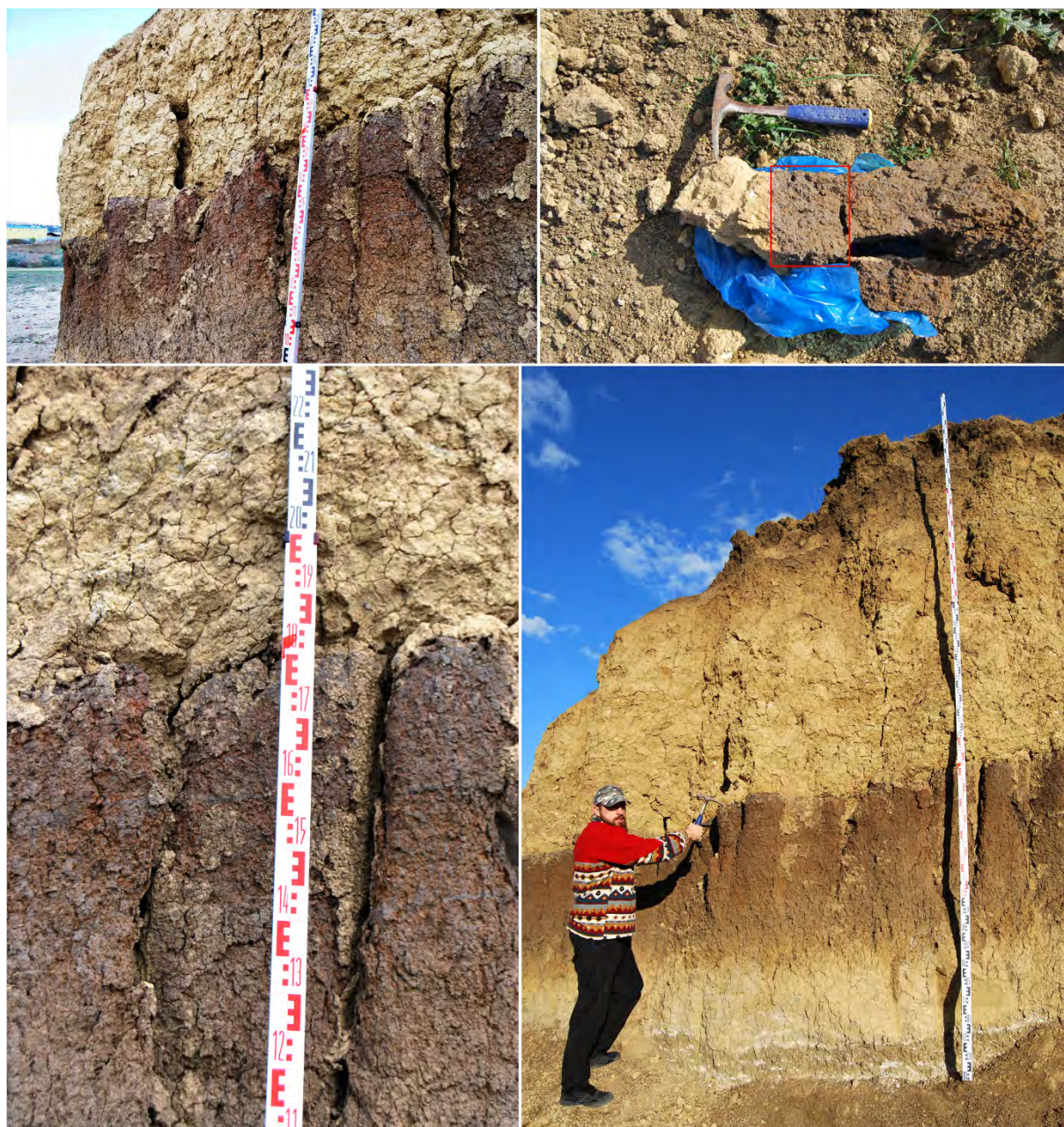
Figura 284. Locația probării solului îngropat (dreptunghiul roșu din imaginea dreapta sus) din masa alunecării recente de la Cucuteni-Lețcani (jud. Iași).
