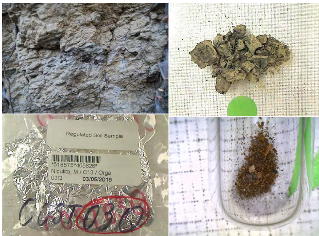
Figura 268. Probă de material vegetal incarbonizat prelevată din depozitele de terasă care acoperă alunecare fosilă Costești (jud. Iași).
