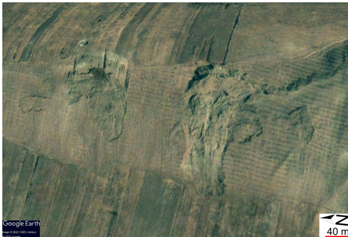
Figura 27. Alunecări translaționale și compuse rotaționale-curgeri pe valea Prutului, la nord-vest de Stănițești (jud. Vaslui); imagine satelitară din arhiva Google Earth.
