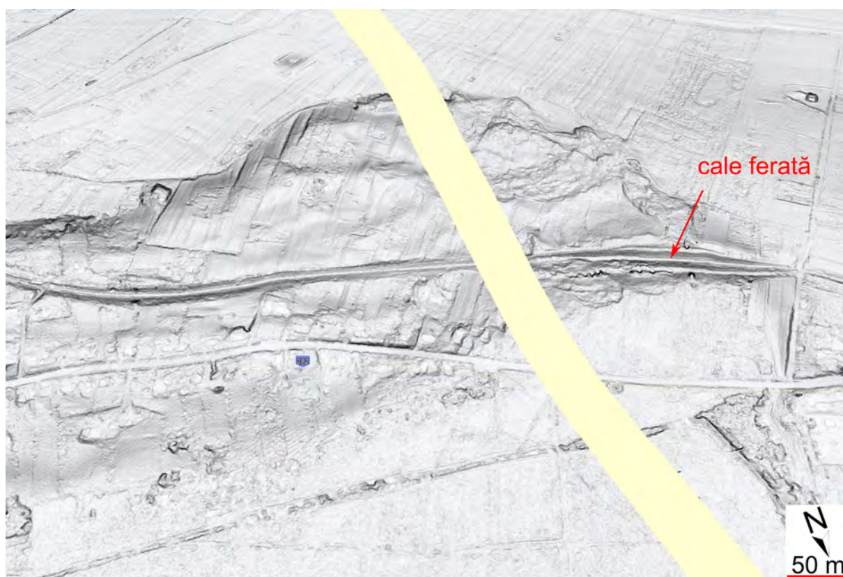
Figura 318. Calea ferată Dângeni-Săveni, la ieșire din Vlășinești; umbrire MNT LiDAR cu rezoluție de 0,5 m.
