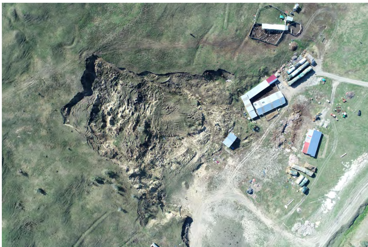
Figura 177 Cariera de argile în lateralul DJ248B între Lețcani și Cucuteni, care a determinat reactivarea masei alunecate a unei alunecări vechi, pre-medievale (a se vedea capitoul dedicat datărilor).
