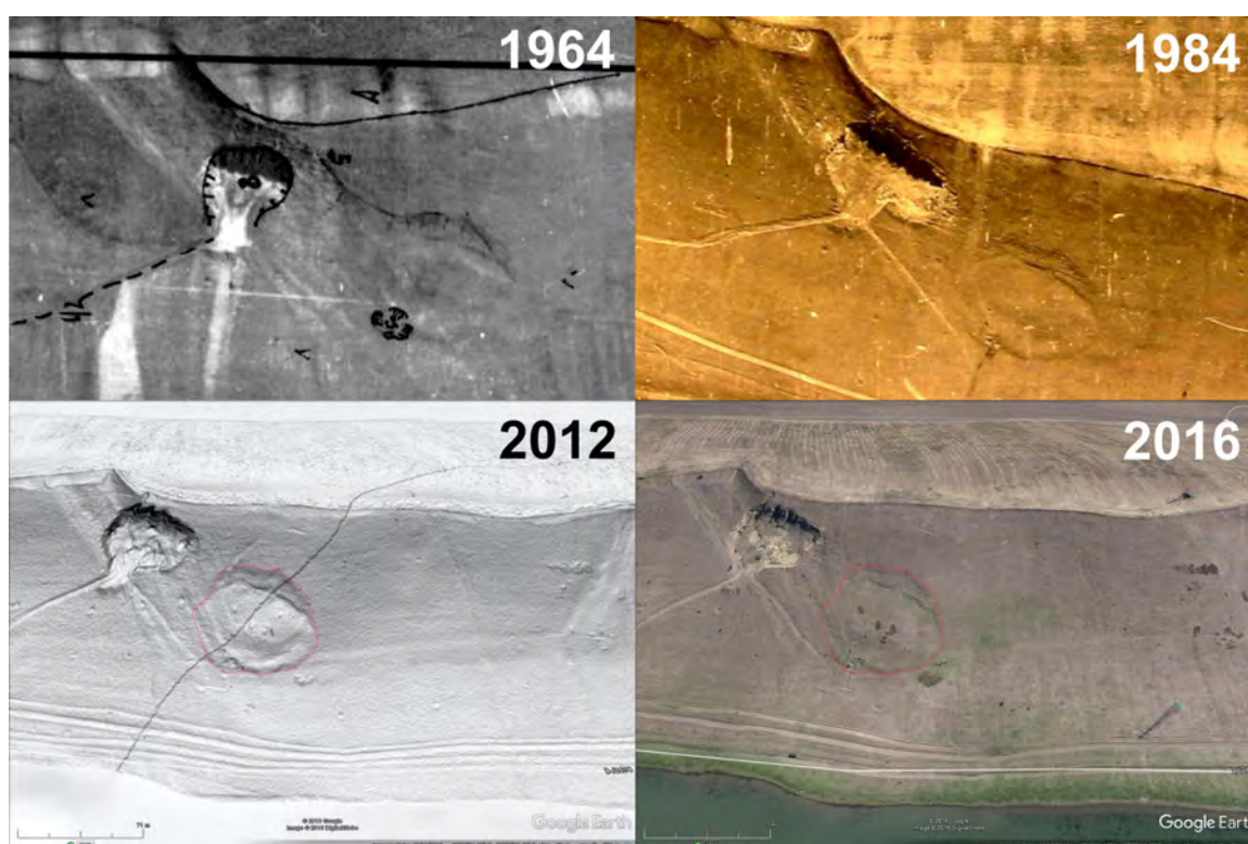
Figura 189. Reprezentarea unei alunecări de teren translaționale de pe versantul stâng al acumulării Chirița pe imagini satelitare și pe imagini aeriene sau MNT LiDAR (Niculiță ș.a., 2018a); imaginile aeriene sunt din 1964; alunecarea de pe versantul Chirița are în proximitate o carieră de nisipuri, care poate foarte ușor asociată unei alunecări de teren pe imaginile aeriene, dar validarea în teren și recunoașterea pe MNT LiDAR pot releva adevărata natură a acestei morfologii.
