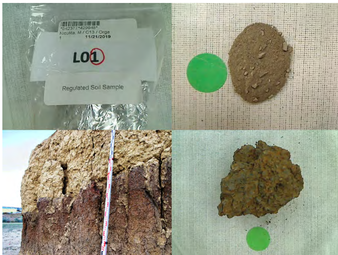
Figura 274. Probă bulk din paleosolul din masa alunecării Lețcani (jud. Iași).
