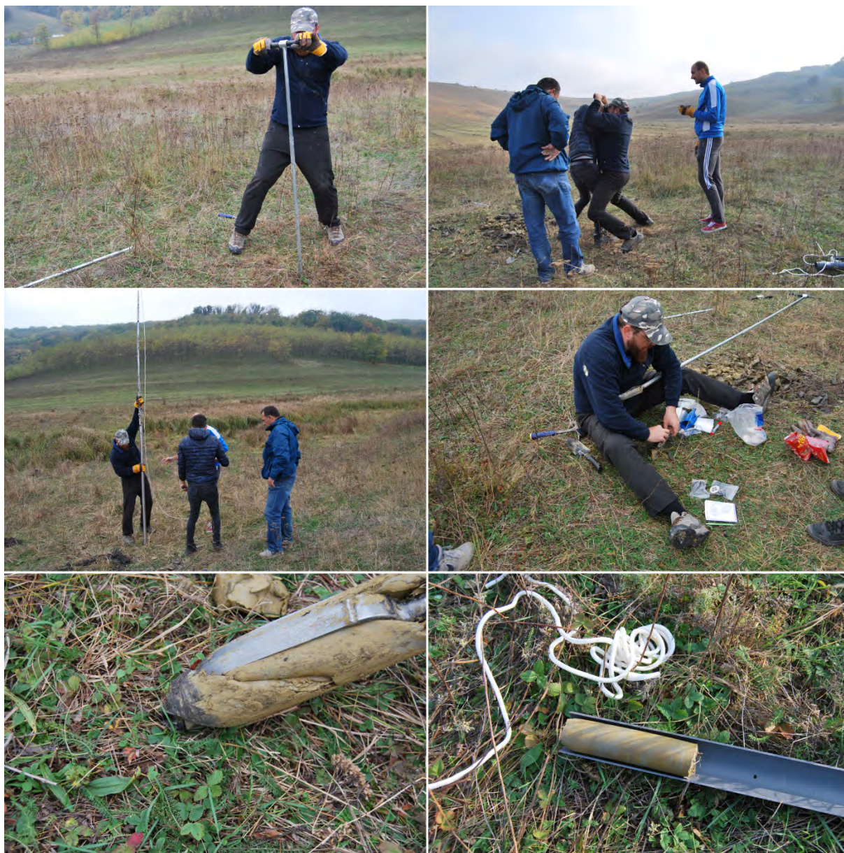
Figura 285. Utilizarea pistonului prelevator pentru obținerea de probe în cazul alunecării de la Breazu (jud. Iași).
