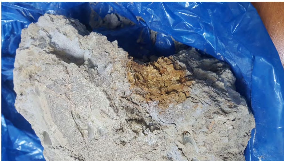
Figura 278. Probă de material lemnos prins în matrice argiloasă.
