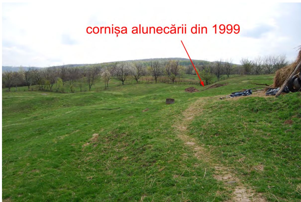
Figura 313. Detaliu pe teren a cornișei alunecării Todirel; cornișa nu depășește 2 metri și este înierbată.
