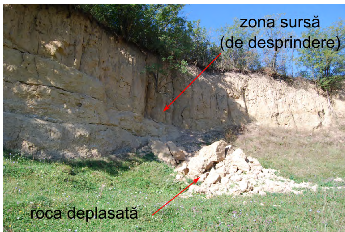
Figura 5. Cădere de loess în cornișa alunecării de teren Berza (Niculiță și Mărgărint, 2017a) (jud. Botoșani).
