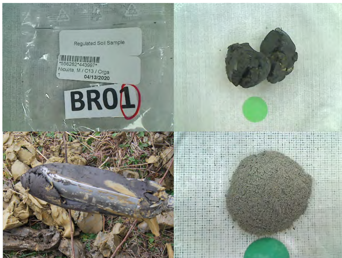
Figura 270. Probă bulk din solul aluvial prins sub alunecarea Breazu (jud. Iași).
