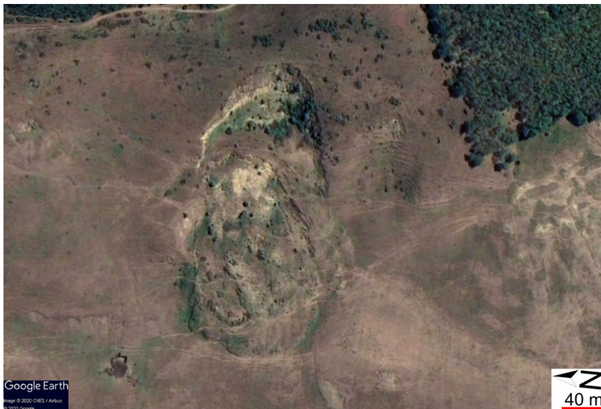
Figura 19. Alunecare rotațională cu o reactivare translațională pe masa alunecată pe valea Lohan, la nord-vest de Duda-Epureni (jud. Vaslui); imagine satelitară din arhiva Google Earth.
