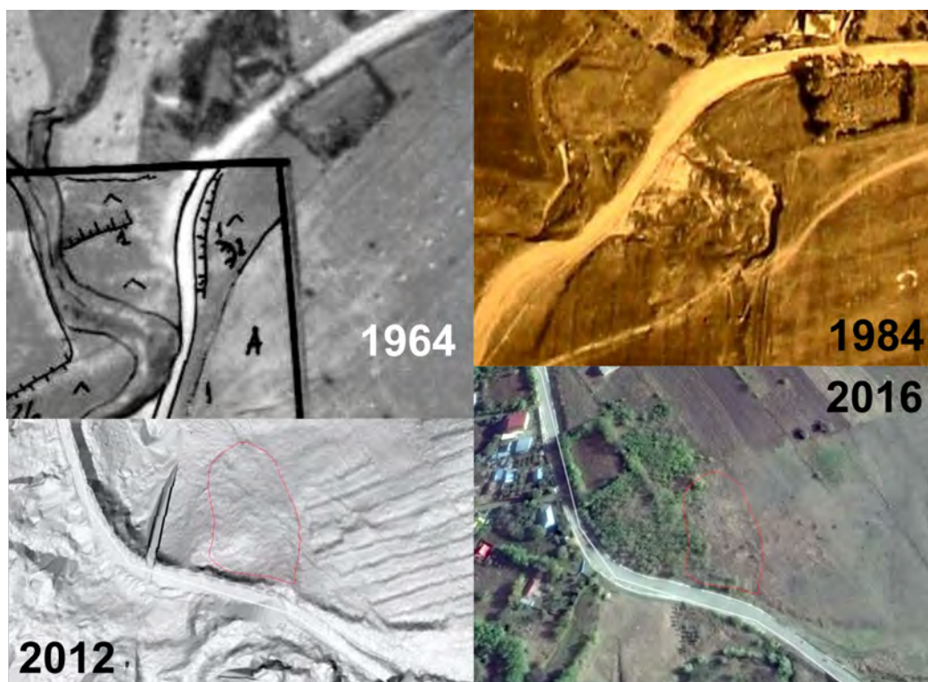
Figura 191. Reprezentarea unei alunecări de teren translaționale de tip colaps, declanșată de adâncirea albiei pârâului Orzeni, comuna Holboca (Niculiță ș.a., 2018a); această alunecare declanșată după 1964 și înainte de 1984, a fost ulterior eliminată prin remodelarea versantului.
