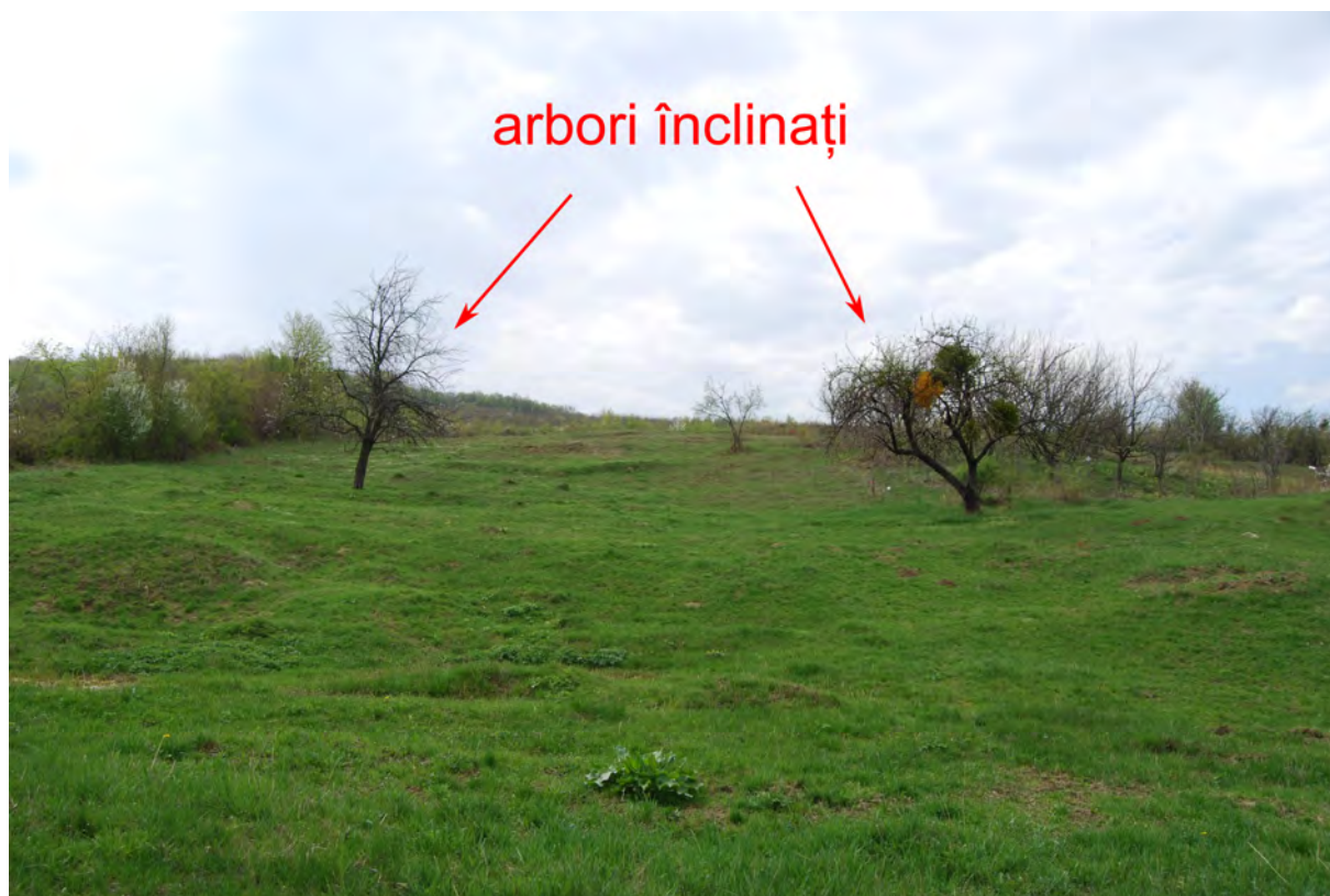
Figura 314. Detaliu de teren al efectelor alunecării Todirel: arbori înclinați.
