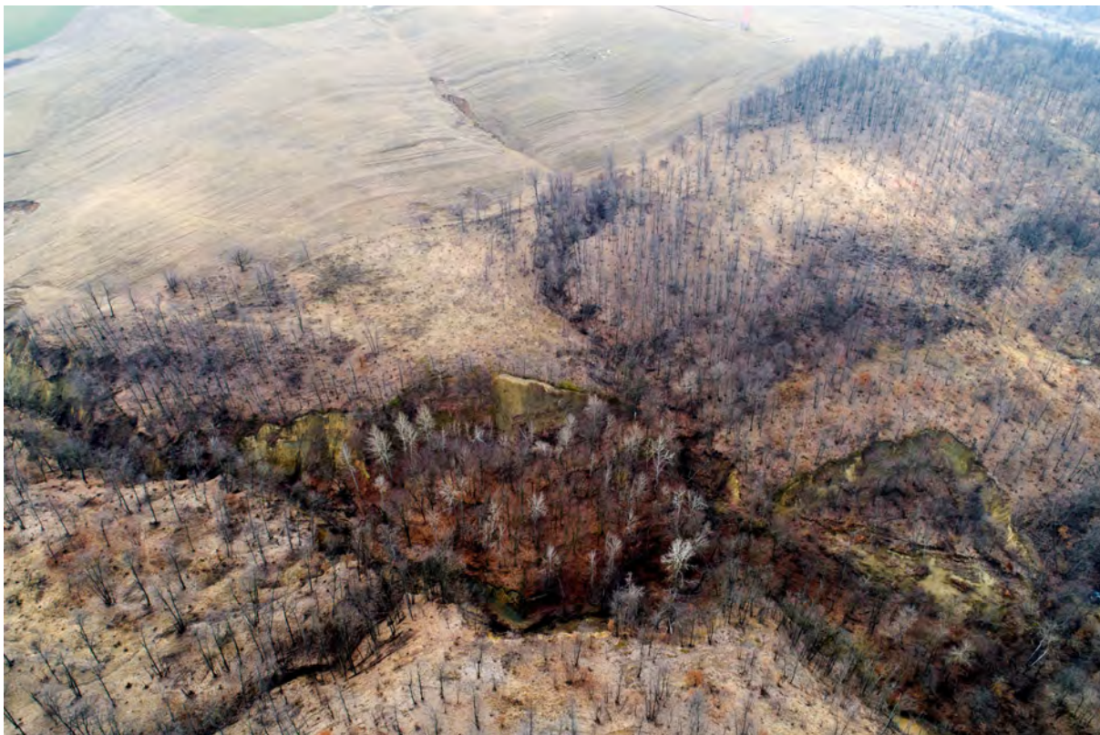
Figura 163. Alunecări de teren declanșate de adâncirea ravenei Valea Cetății Vladnic, la est de Corni-Albești (jud. Vaslui).
