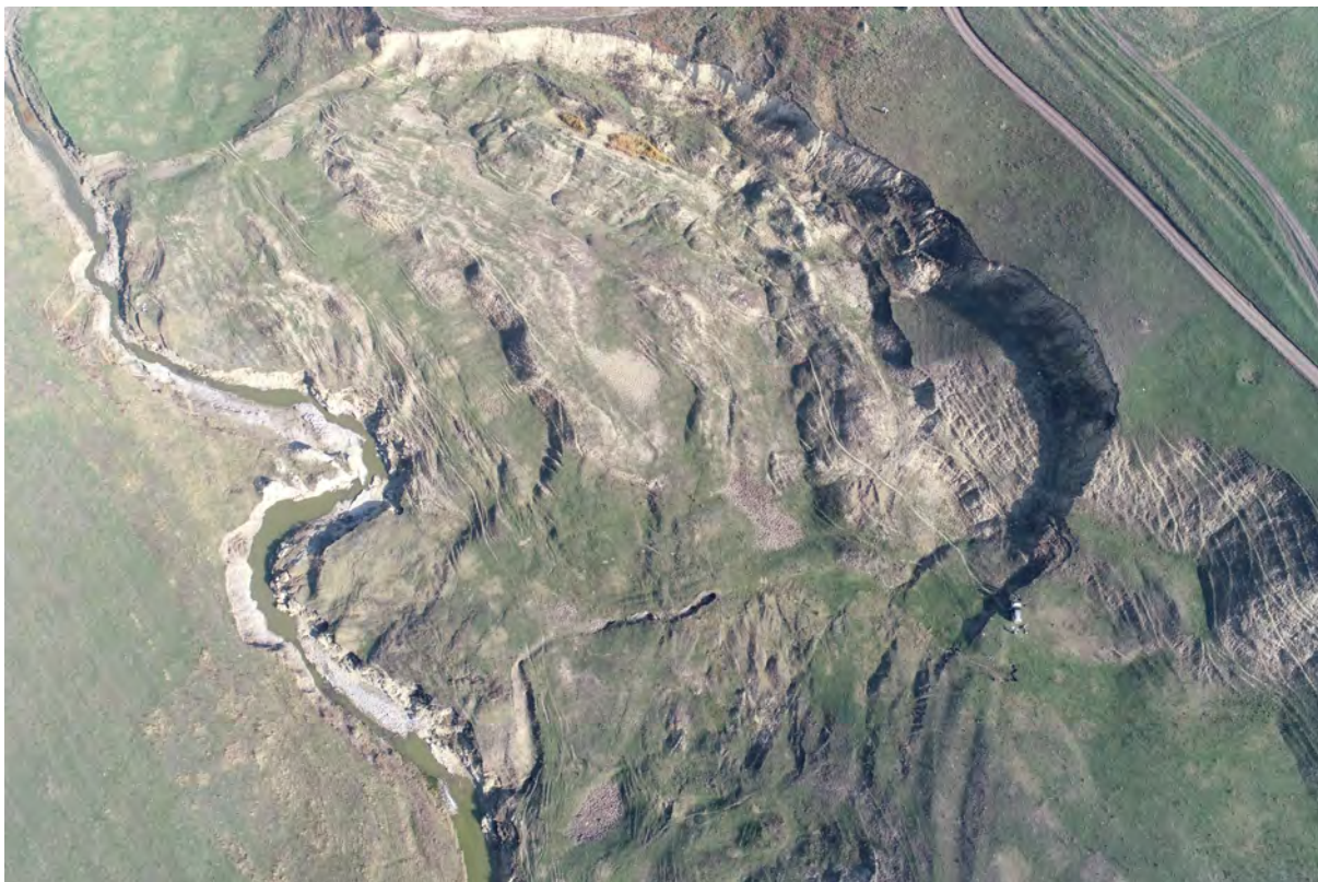
Figura 154. Alunecarea de teren Șipote, declanșată și întreținută de adâncirea și eroziunea laterală a albiei râului Miletin (Șipote, jud. Iași) – imagine aeriană din 2019.
