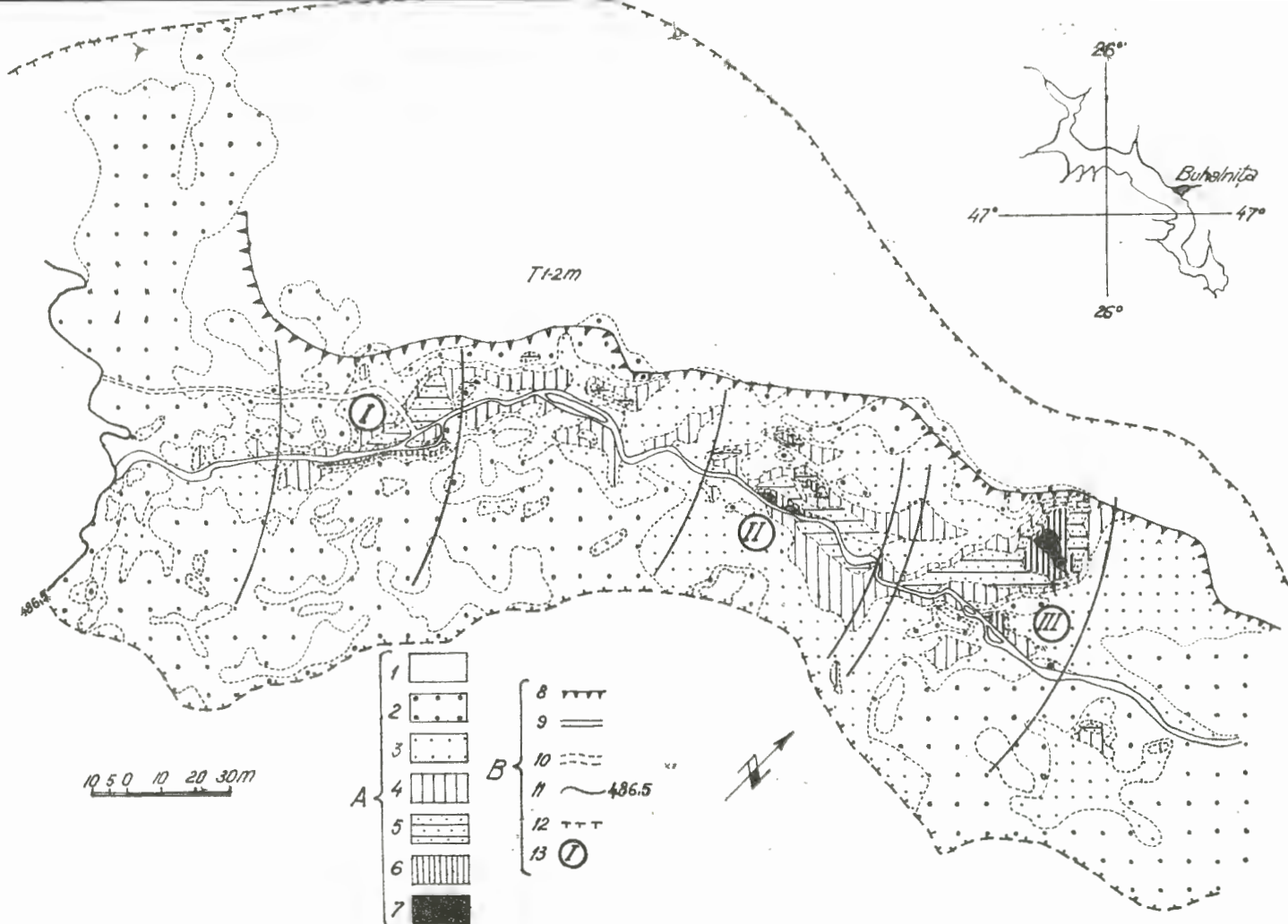
Fig. 3. — Golfe de Buhalnița (lac Izvoru Muntelui). Épaisseur des dépôts lacustres le 23 avril 1974. A, Épaisseur des sédiments : 1, sous 10 cm ; 2, entre 10 et 20 cm ; 3, entre 20 et 40 cm ; 4, entre 40 et 60 cm ; 5, entre 60 et 80 cm ; 6, entre 80 et 100 cm ; 7, plus de 100 cm. B, 8, front de terrasse ; 9, lit actif creusé dans des dépôts lacustres ; 10, lit abandonné creusé dans dépôts lacustres ; 11, ligne de rivage du lac le 23 avril 1974 ; 12, limite de l'aire à terrasses du fond du golfe ; 13, aires d'individualisation des micro-deltas
