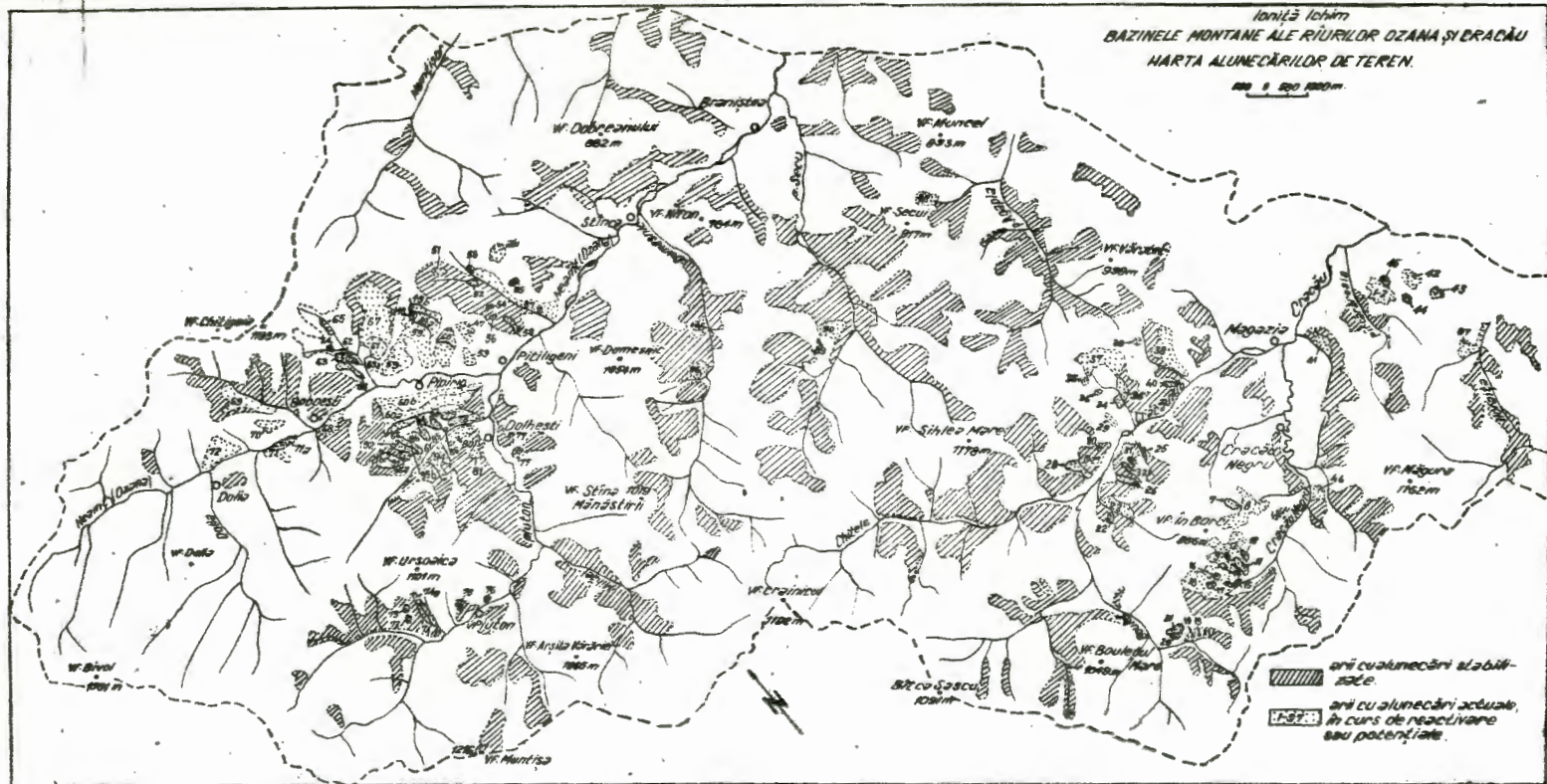
Fig.1. Bazinele montane ale rîurilor Ozana și Cracău. Harta alunecărilor de teren. 1. arii cu alunecări stabilizate; 2. arii cu alunecări actuale în curs de reactivare sau potențiale. Mountainous river basin Ozana and Cracău. Landslide map. 1. lands with stable landslides; 2. active landslides.
